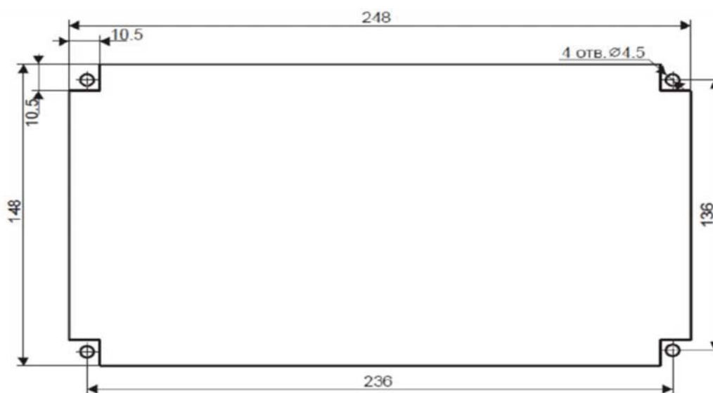
Рисунок 4 - Доработка панели для установки M927L2
