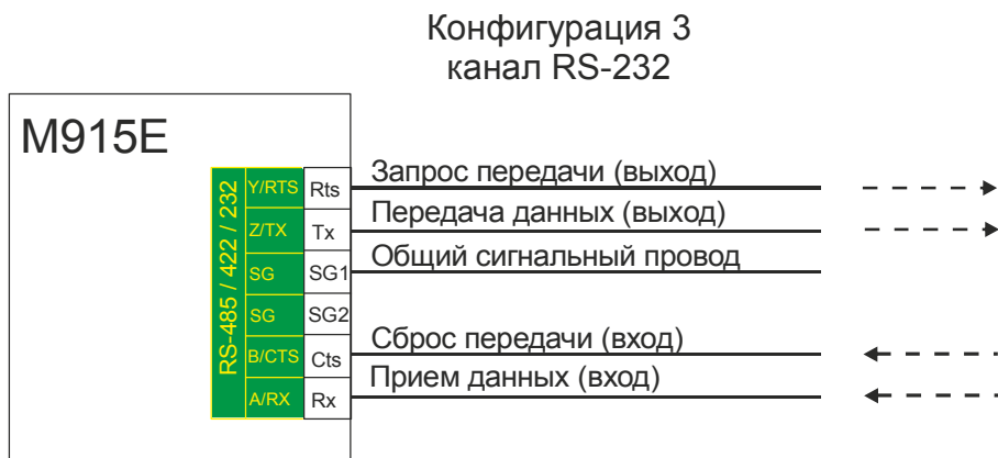
Рисунок 6 - Подключение внешних цепей к интерфейсу RS-232
