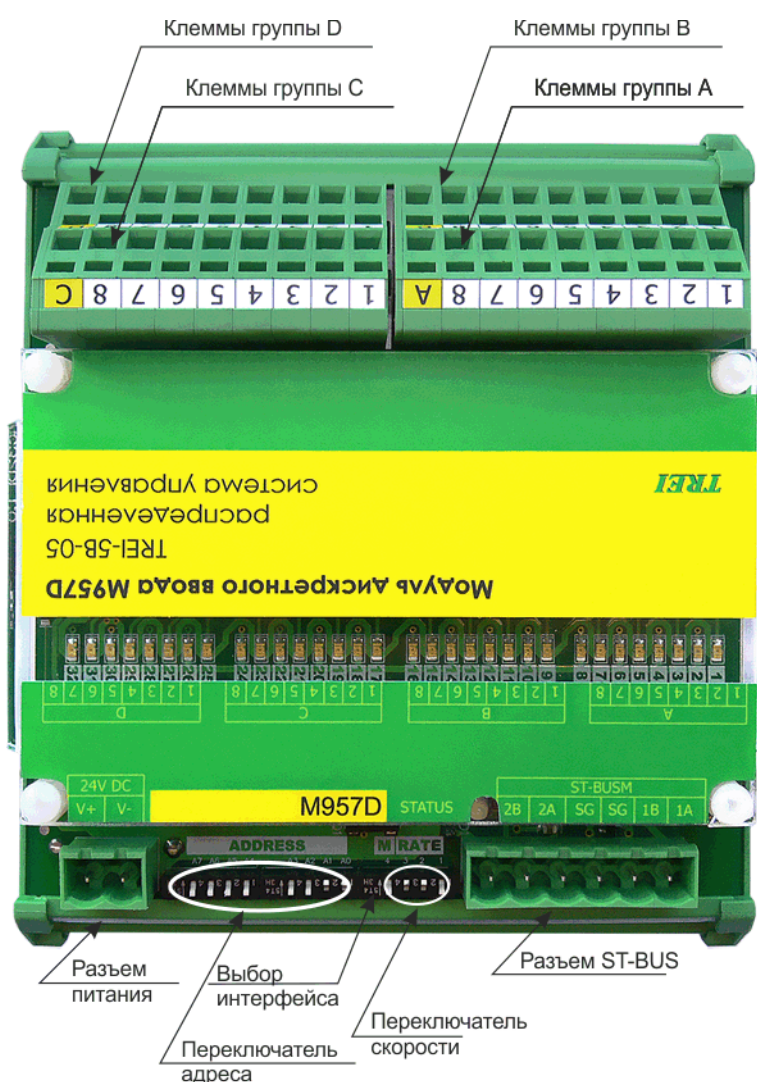
Рисунок 1 - Разъемы и лицевая панель модуля M957D
