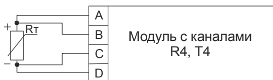
а) 4-проводная схема подключения
