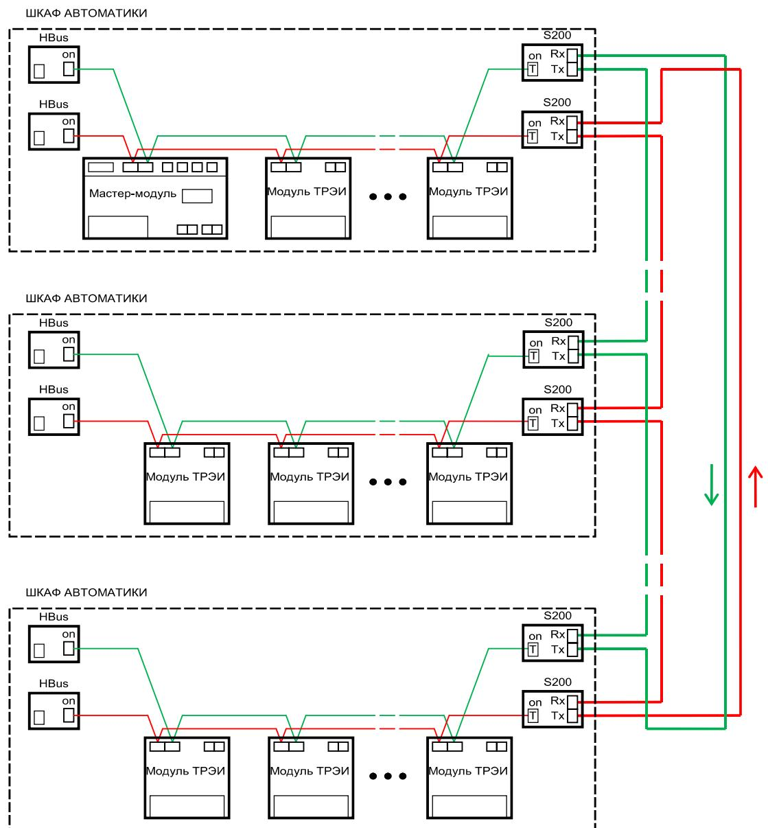
Рисунок 6 – Схема подключения «кольцо» (для серии TREI-5B-05 SMART-TP)
