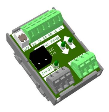
Рисунок 1 - Общий вид повторителя S210
